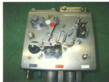
ガスロック復帰状態
